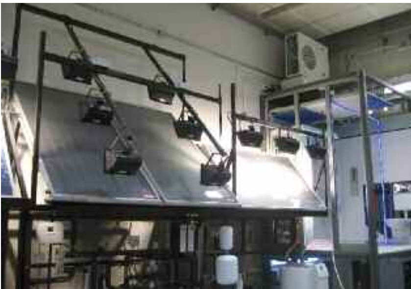
A modo de falsos soles unos focos sustituyen a los rayos solares en una instalación solar interior.
