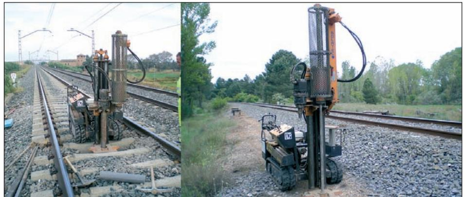
[Figura 15].- Los ensayos de penetración dinámica tipo DPSH pueden ser un buen ensayo para verificar el estado de compactación del material donde apoya el sub-balasto. Debido a la alta energía de este ensayo se puede obtener un perfil de golpeo de bastantes metros, en la vertical, de la plataforma. Cuanto mayor sea la compactación de la plataforma menos bajará este ensayo. Puede permitir evaluar la magnitud de los asientos postconstructivos en obras nuevas.
