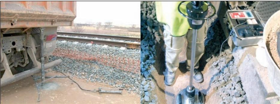
[Figura 13].- Ensayo de Placa Estática (izquierda) y Dinámica (derecha) del sub-balasto. Actualmente ambos ensayos son correlacionables permitiendo el segundo mayor operatividad al no necesitar de un peso de grandes dimensiones (camión) para aplicar la carga, aparte de ser más rápido de ejecución.
