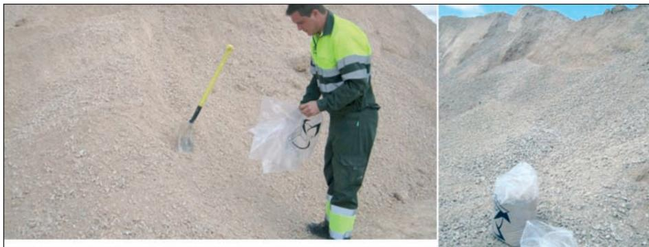
[Figura 4].- Aspecto del sub-balasto en una zona de acopio. Su granulometría y definición bajo la Gráfica de Casagrande coincide con el de una grava arenosa bien graduada. Recogida de muestras para los análisis preceptivos en laboratorio.
