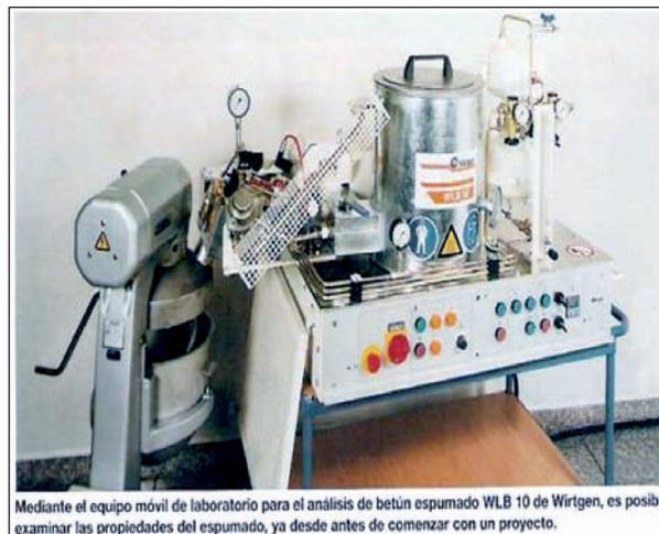
■ [Figura 14] .- Planta de laboratorio de espuma de betón.
