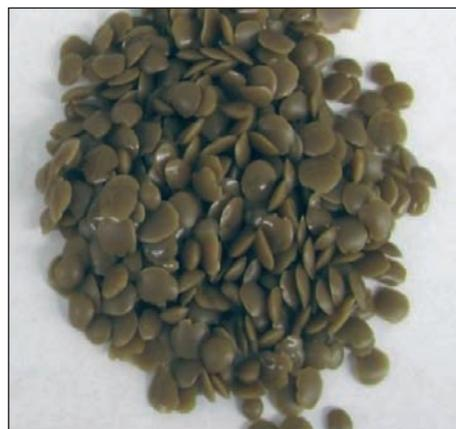
[Figura 8].- Presentación típica de aditivo para vía seca.
