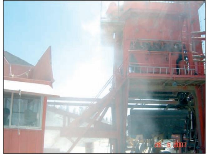
■ [Figura 12] .- Fabricación de mezcla semicaliente por espumación inducida.
