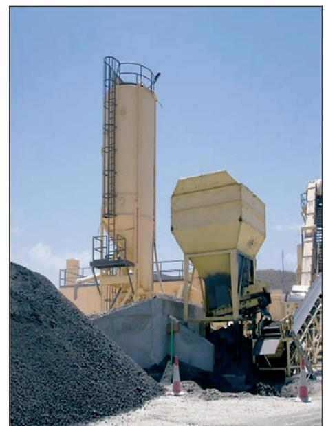
[Figura 4] .- Acopio de RAP y planta para reciclado en caliente de alta tasa.
