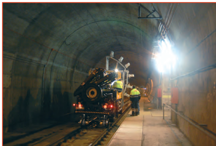
El equipo tunnelings permite escanear el perfil del túnel y detectar posibles fisuras en el mismo.
