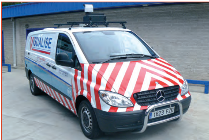
Equipo Visualise para medir la reflectancia de las señales.
