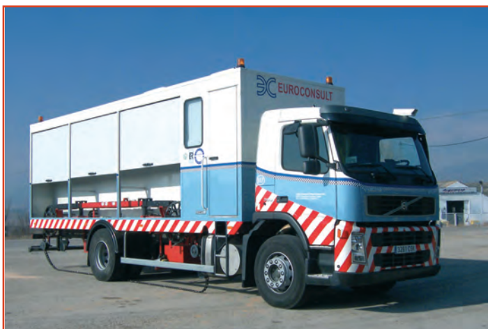
Curviómetro, equipo para medir las deformaciones del firme.
