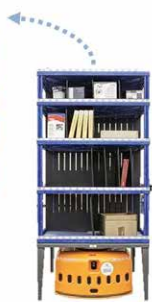
Transporte automático de bastidores de almacén a la estación de trabajo
