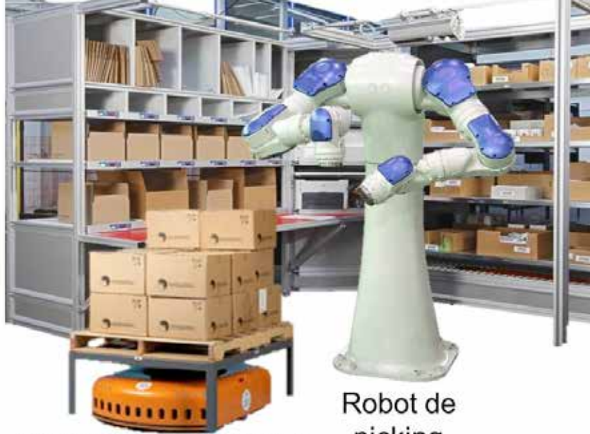
Transporte automático de cajas de entrega a la zona de expedición
