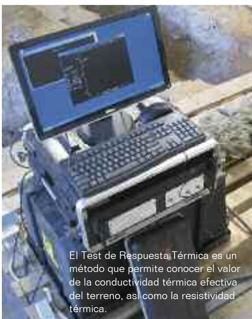
El Test de Respuesta Térmica es un método que permite conocer el valor de la conductividad térmica efectiva del terreno, así como la resistividad térmica.
