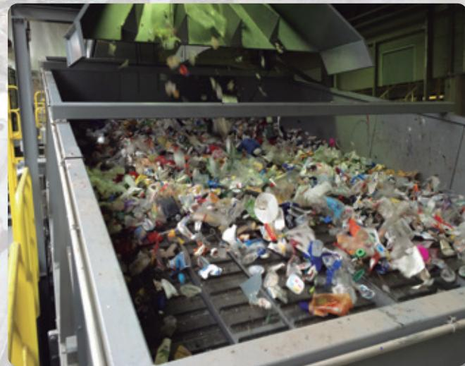
El separador balístico SUTCO es una máquina utilizada para separar una corriente de material de entrada en dos o tres fracciones. La gran ventaja del separador balístico SUTCO en comparación con otros dispositivos de separación es la combinación del método de clasificación en peso, dimensión, densidad y forma.
