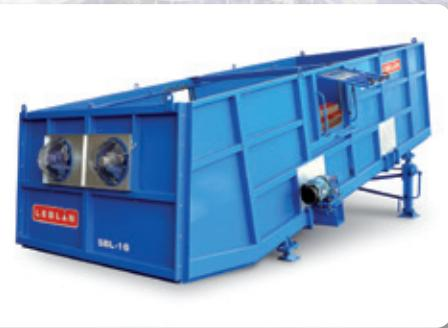
Los separadores balísticos de LEBLAN realizan la clasificación de los residuos en tres fracciones: ligera/plana, pesada/rodante y finos. Esta separación se produce por las distintas formas, densidades y tamaños de los materiales que se procesan.
