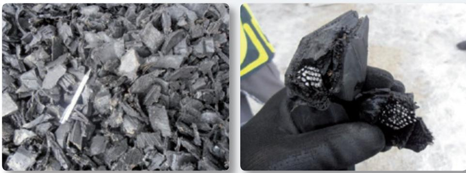
Figura 3. Fotos de un triturado de NFVU de tamaño regular y corte limpio presentado por PRECIMECA. | Figure 3. Images of clean-cut, regular-sized shredded ELT presented by PRECIMECA.
