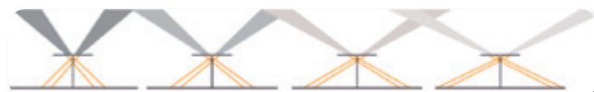
Figura 4. Cálculo de sombras producidas por la viga de torsión Figure 4. Torque tube shade calculation
