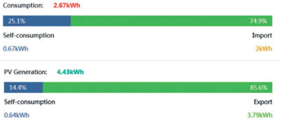
Figura 4. El portal eSolar muestra la proporción de autoconsumo del sistema fotovoltaico. | Figure 4. eSolar Portal shows proportion of self-consumption in PV system
