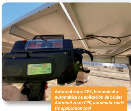
Autotool 2000 CPK, herramienta automática de aplicación de bridales
