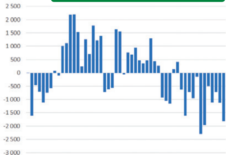
Gráfico 1. Déficit/superávit entre producción y consumo eléctrico a lo largo de un año en un sistema electrificado, en GWh | Graph 1. Yearly deficit/surplus between energy production and consumption in an electrified system, in GWh
