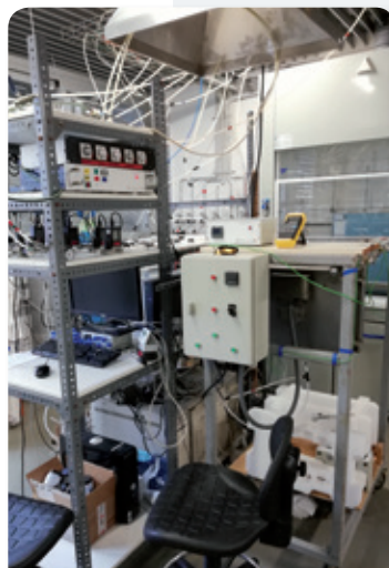
Banco de metanación instalado en el centro I3A | Methanation test bed installed at the I3A centre
