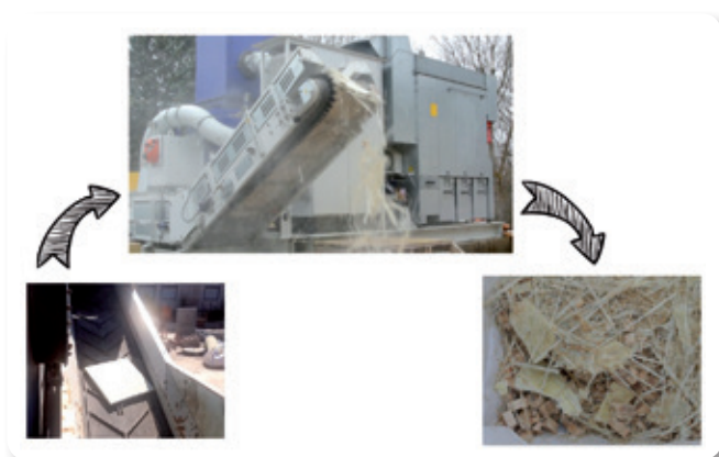
Figura 5. Primera etapa. Entrada trozo de pala (izq.), molino en funcionamiento (arriba), producto obtenido (derecha). | Figure 5. First stage. Blade piece input (left), mill in operation (top), output product (right).
