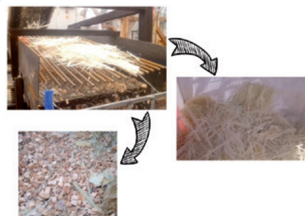
Figura 7. Segunda etapa. Madera y resina (abajo), mesa vibrante en funcionamiento (arriba), fibras de vidrio separadas (derecha) | Figure 7. Second stage. Wood and resin (bottom), vibrating table in operation (top), separated glass fibres (right)
