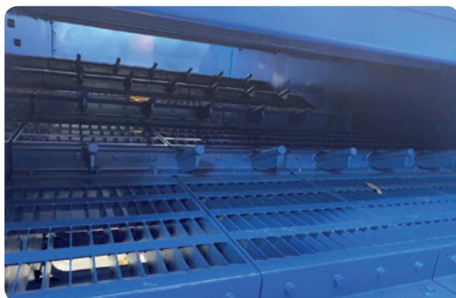
Dotada con un sistema de chasis subresonante que amplifica la vibración del chasis principal, alcanzan aceleraciones sobre los paños de hasta “50 G”.
