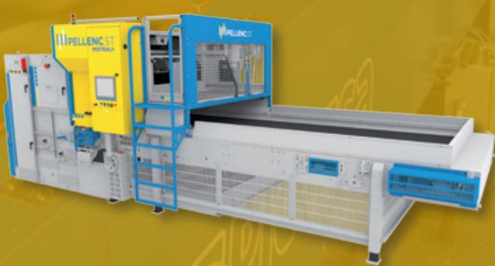
Pellenc ST fabrica equipos de clasificación óptica para el tratamiento de residuos y para la industria del reciclaje. Los flujos que son clasificados provienen de mercados de residuos de envases, de industria, de electrónicos, automovilísticos y de construcción. Las tecnologías que se utilizan para la clasificación de estos materiales son la espectrometría próxima infrarroja, la visión, la inducción y los rayos X. Las máquinas Pellenc ST han sido instaladas en más de 40 países.
