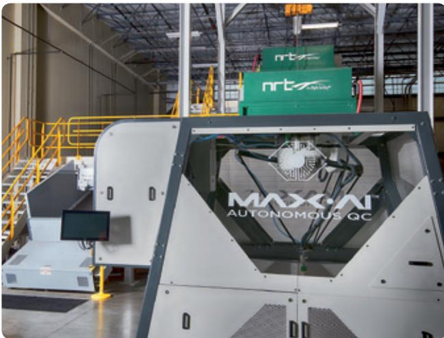
complementar la avanzada tecnología de separación de pantalla, aire y óptica ya en uso. Integrándose perfectamente con los separadores ópticos existentes de la compañía NRT, los equipos Max-AITM proporcionan una solución totalmente autónoma de la clasificación de PET, realizando el control de calidad del flujo de PET durante los dos turnos diarios de la planta.
