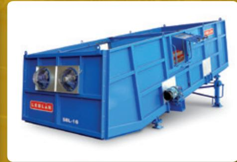
Los separadores balísticos de LEBLAN realizan la clasificación de los residuos en tres fracciones: ligera/plana, pesada/rodante y finos. Esta separación se produce por las distintas formas, densidades y tamaños de los materiales que se procesan.
