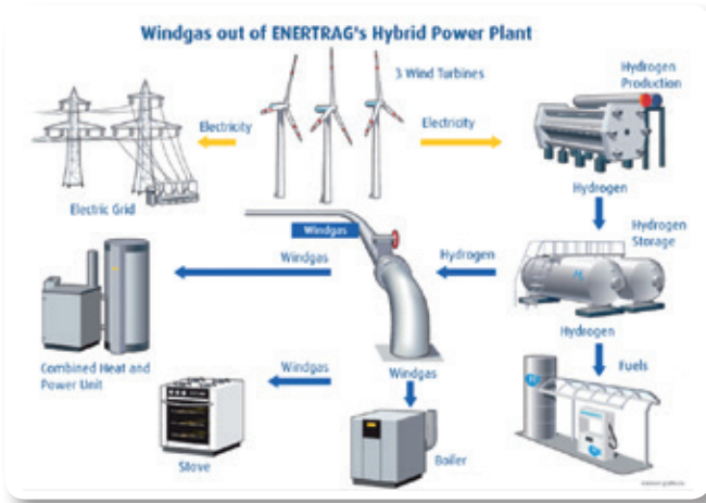
Figura 1. Conversión de excedentes de energía renovable en hidrógeno. Fuente: Enertrag Figure 1. Converting surplus renewable energy into hydrogen. Source: Enertrag
