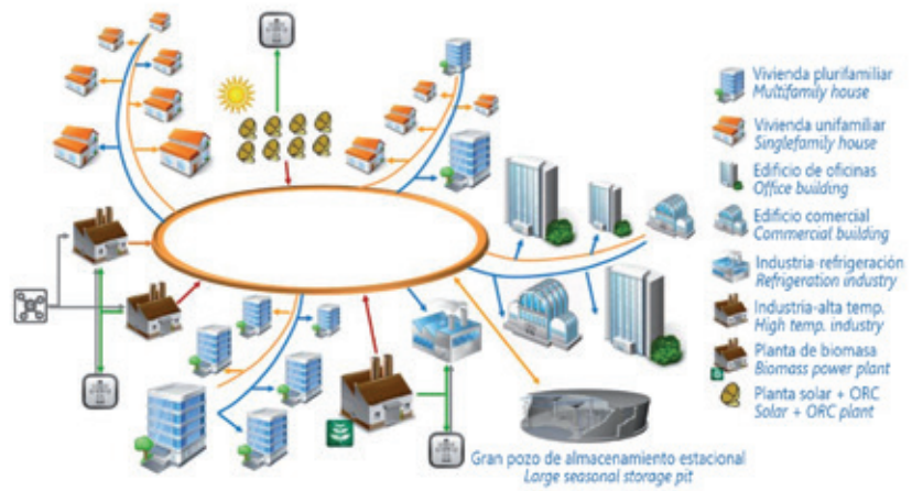
Hipotética red de calefacción y refrigeración urbana basada en el concepto de bucle de agua Hypothesis of DHC network based on the water-loop concept
