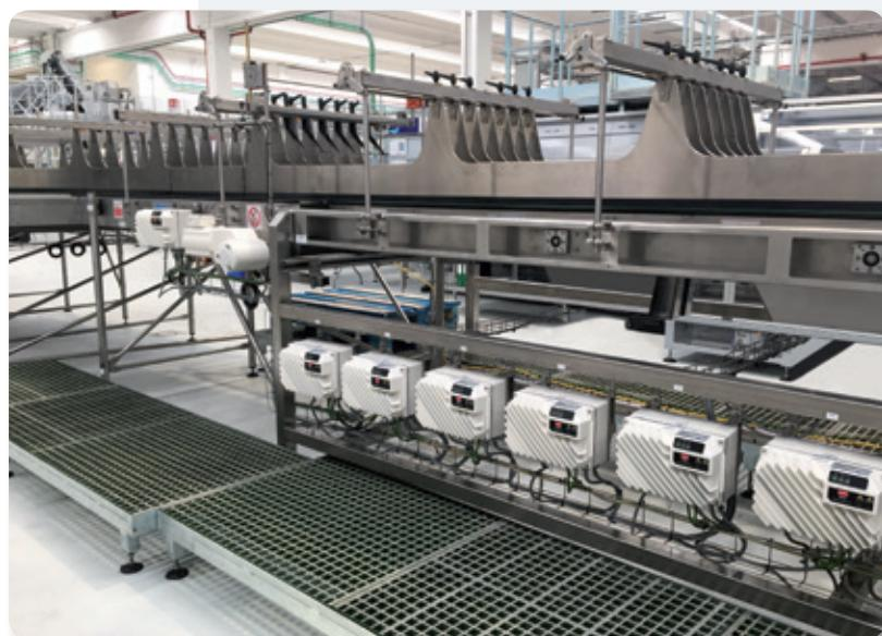
ta los niveles de higiene, que son tan importantes en las líneas de embotellado. Su funcionamiento sin ventilador asegura un nivel de ruido más bajo y que los gérmenes transportados por el aire y las partículas de polvo no entren en el motor y luego sean expulsadas de nuevo al aire circundante, un aspecto también importante desde el punto de vista de la higiene.
