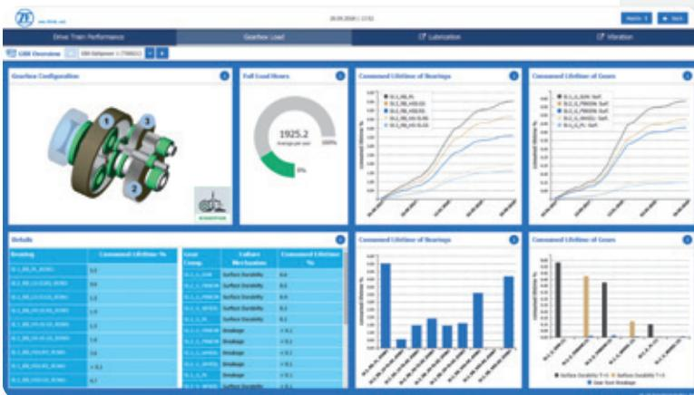
se podrán implementar las contramedidas adecuadas para evitar condiciones críticas de funcionamiento y, en consecuencia, extender la vida útil de los rodamientos. Así, los operadores de parques eólicos tendrán a su disposición una herramienta que amplía significativamente sus horizontes de planificación.
