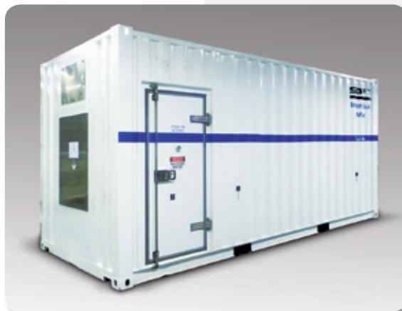
Los sistemas de almacenamiento de energía en contenedores Li-ion de Saft a escala de megavatios, para redes y fuentes de energía renovable, suavizan la generación intermitente y las tasas de desnivel, y proporcionan apoyo para la gestión de picos de consumo y de la tensión. Saft's megawatt-scale Li-ion containerised ESSs for grids and renewable energy sources, smooths intermittent generation and ramp rates, as well as peak management and voltage support.
