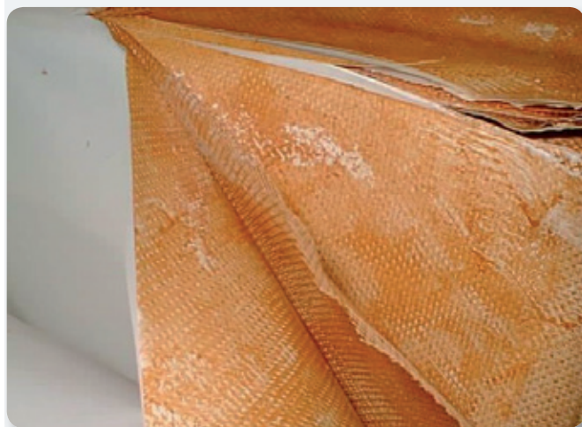
Figura 1. Membrana de ósmosis inversa sin ensuciamiento (izquierda) y con ensuciamiento por efecto de hierro (derecha). | Figure 1. Reverse osmosis membrane without fouling (left) and membrane with iron fouling (right).
