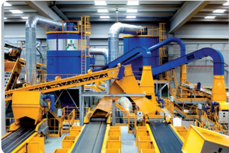
cación fundamental en fracción seca y húmeda, valorización material de la fracción seca mediante selección de materiales reciclables y producción de combustible secundario de residuos para cementeras.
