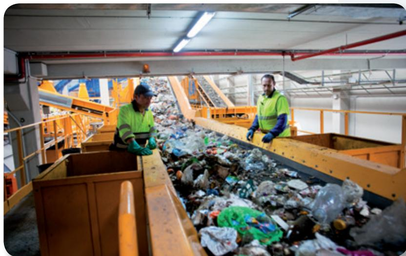
BRIX que son introducidos en la cabina de selección manual para su separación final por operarios de selección que garantizan la máxima pureza de las fracciones. Los materiales no seleccionados por el separador óptico son reintroducidos en el pre-triturador para ser reprocesados en la línea de valorización material de manera que se compensen posibles errores en la primera pasada, garantizando que no se pierdan materiales reciclables por el rechazo fin de línea.
