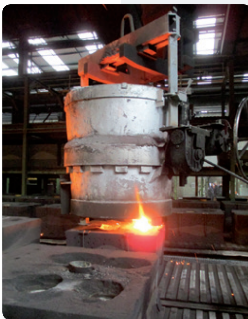
Colada de acero en molde de arena en la fundición Steel being poured into sand mould in the foundry
