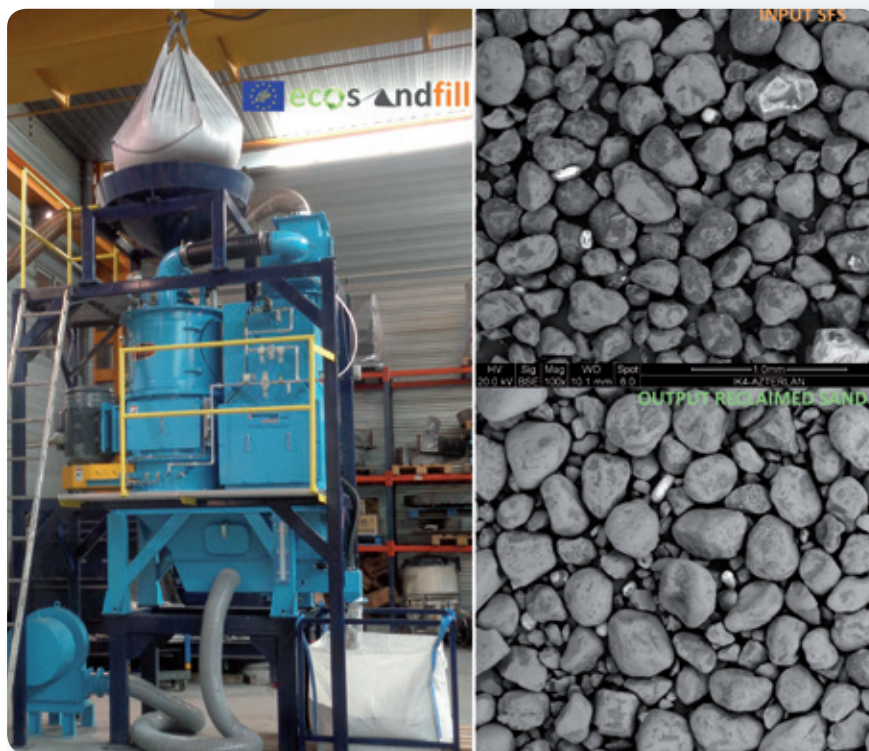
Vista general del prototipo de regeneración mecánica (izqda.) e imágenes SEM de muestras de arena residual de fundición antes (dcha. sup.) y después (dcha.inf.) del tratamiento de regeneración | General view of reclamation prototype (left) and SEM images of SFS samples before (right, top) and after (right, bottom) reclamation
