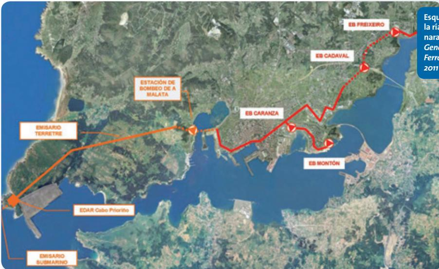
**Esquema general del saneamiento de la margen derecha de la ría de Ferrol tras las primeras obras finalizadas en 2011 (en naranja) y las ejecutadas en la década de los noventa (en rojo)**
