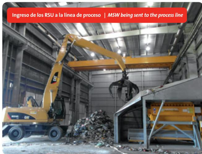
La carga de los residuos para dar inicio a su procesamiento se lleva a cabo con un pulpo grúa de ruedas Caterpillar modelo M322D MH, con brazo flexible y una garra de 1,5 m<sup>3</sup> de capacidad que permite dosificar adecuadamente los residuos a la línea.
