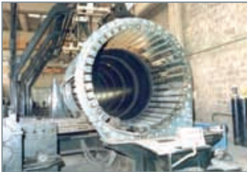
■ Elimaster, máquina para fabricar las camisas de chapa.
