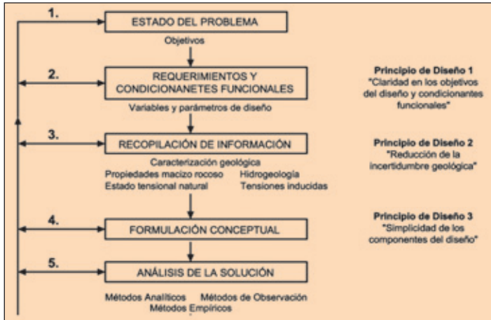
[Figura 1].- Metodología de Diseño y principios de la Ingeniería de Rocas (Bieniawski 1992).
