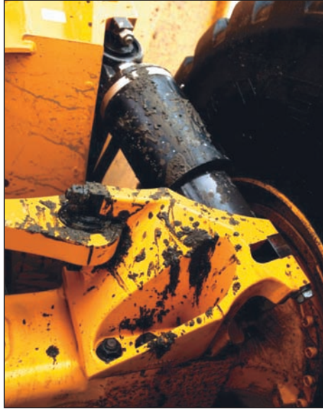
En la suspensión FS, esta es realizada por un cilindro hidráulico en cada una de las ruedas.
