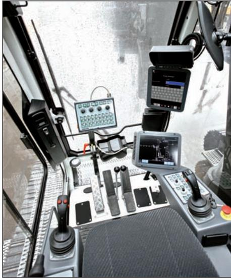
**Sistema PDE de registro de datos del proceso en la cabina de una pilotadora.**
