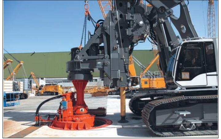
**Vista del nuevo banco de pruebas para ensayos del par de rotación de las pilotadoras.**
