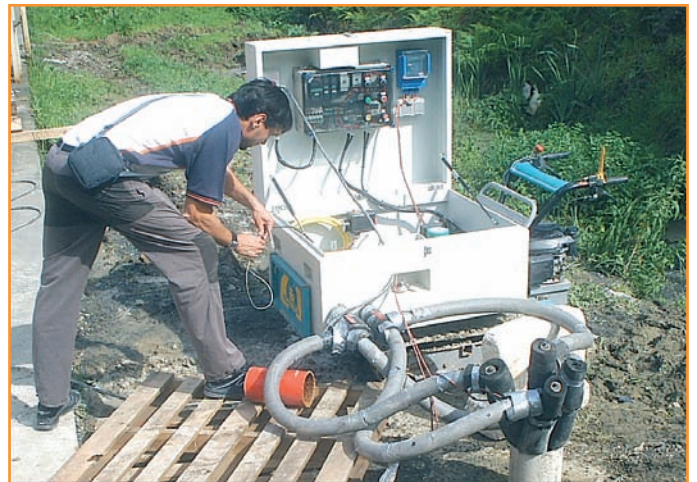
■ [Foto 2] .- Equipo de ensayo de respuesta geotérmica.
