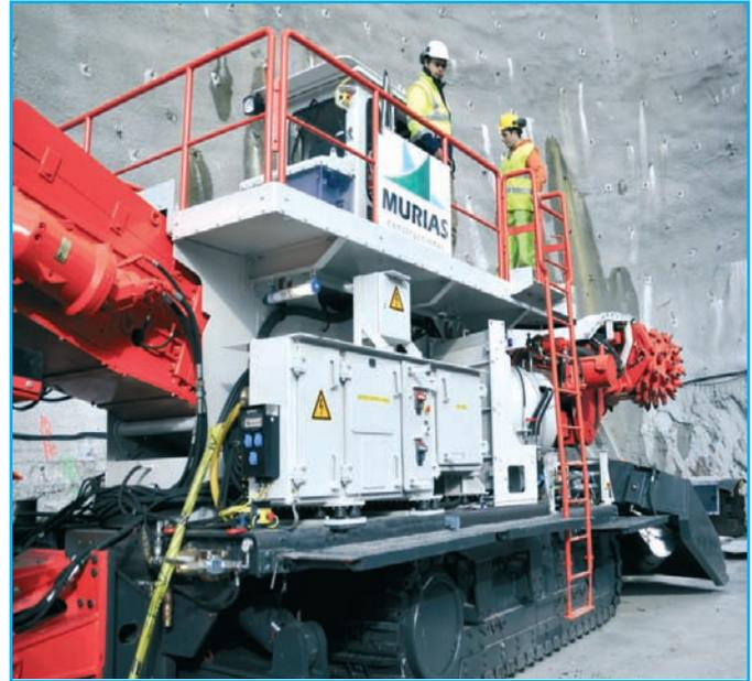
generación, son: la conexión subterránea del aeropuerto de Brisbane (Australia), donde se ha utilizado una rozadora **MT720**, para excavar formaciones con resistencias a compresión desde 10 a 99 Mpa.
