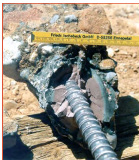
Detalle de la rosca especial continua tipo Titan y el elevado diámetro efectivo obtenido.
