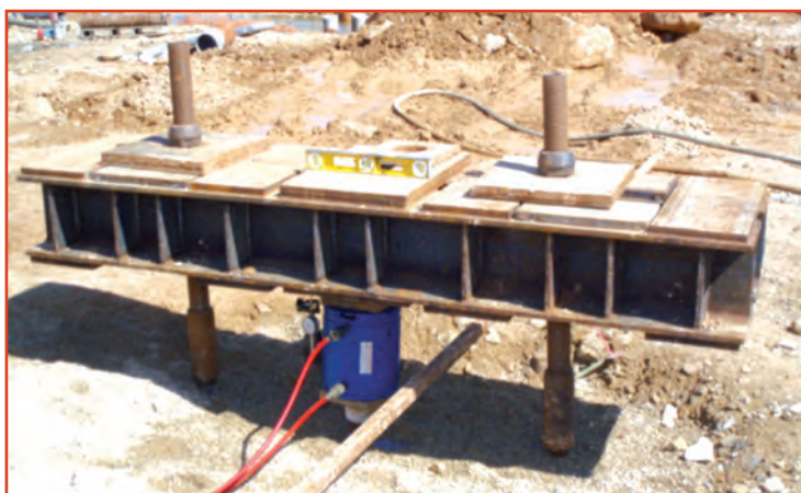
Detalle del Ensayo de Compresión: 2 micropilotes externos de reacción (traccionados), 1 micropilote central para el Ensayo (comprimido), comparadores digitales para medición de acortamientos, pistón del gato de tesado y vigas de reacción.
