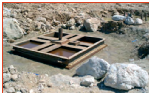
Placa de reparto y lecho de arena para Ensayo de Tracción.
