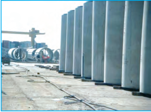
■ Almacenamiento en fábrica de las tuberías.
