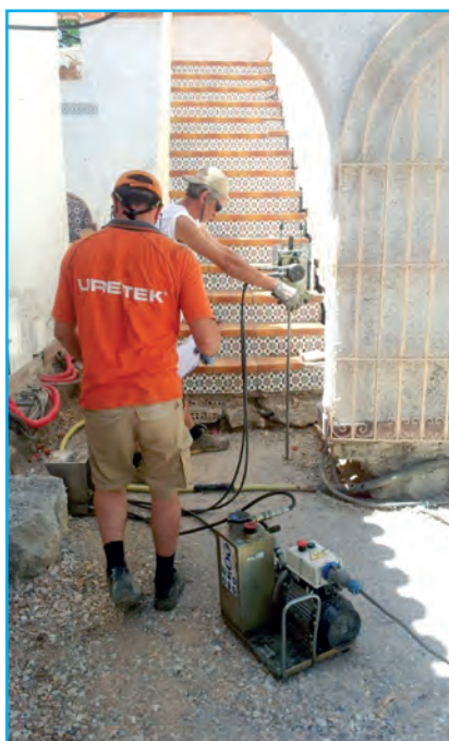
[Figura 7] .- Ejecución de un ensayo penetrométrico.
