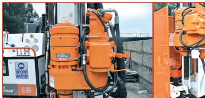
■ **Unidad de rotación PQ y Nitro Chuck patentado.**
