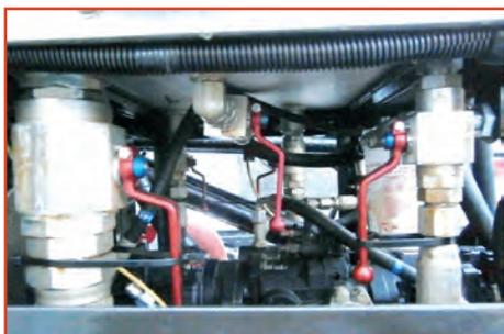
■ **Las válvulas de bola permiten un mejor mantenimiento y menos derrames de aceite hidráulico.**
