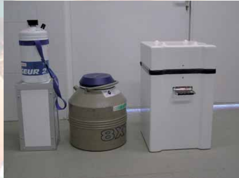
Tanque nitrógeno líquido a -196°C
