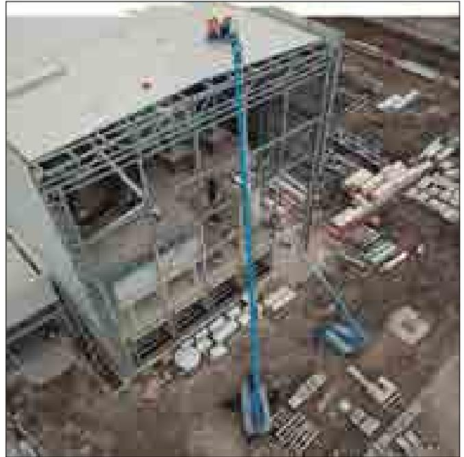
**La Genie SX-135 XC cuenta con un control automático de envolvente que retrae automáticamente la pluma cuando alcanza su envolvente operativa.** © OnSite e Nolo Servizi 2000.
