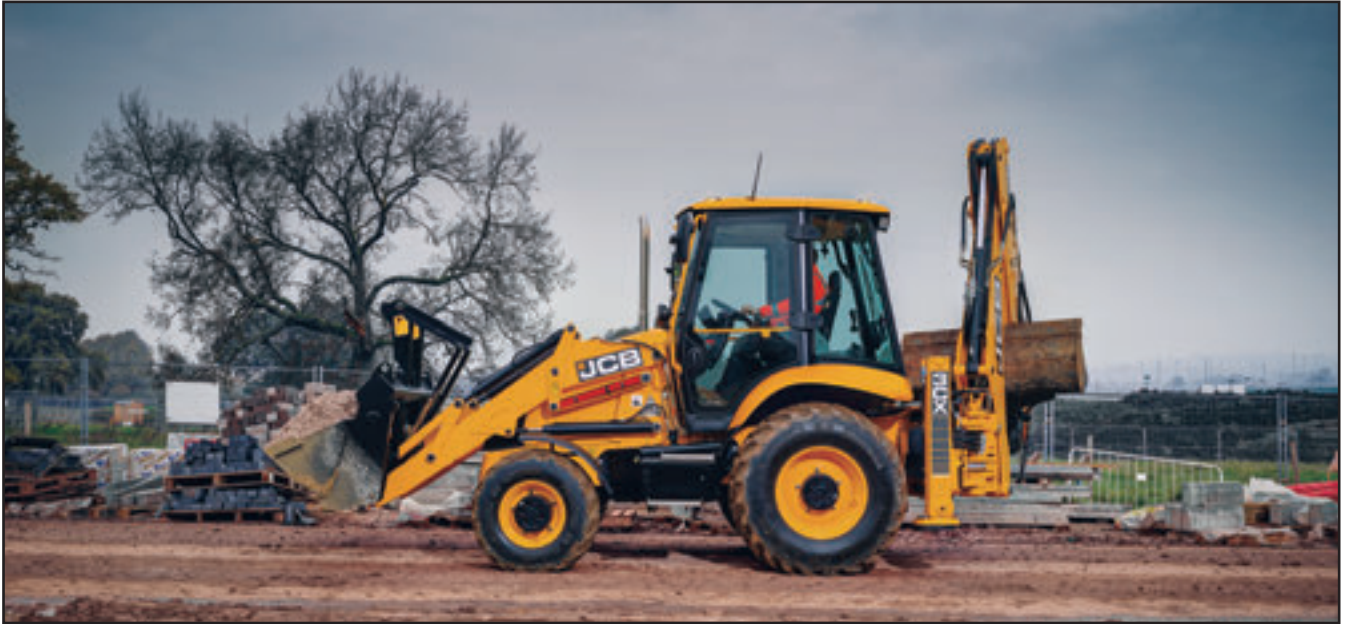
Además de la actualización ECO de la 3CX, JCB ha presentado las versiones PRO de las retroexcavadoras 3CX, 4CX y 5CX, con la adopción de motores que cumplen la fase V en todos los modelos. La 3CX PRO (en la imagen) es una máquina de dos ruedas directrices
