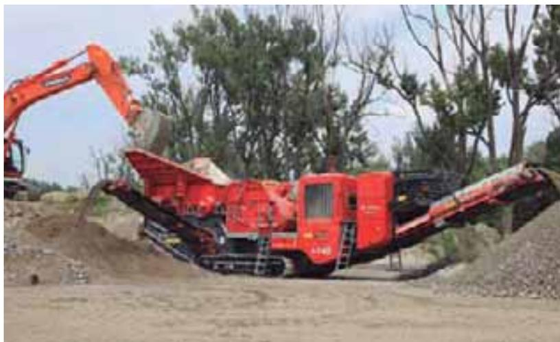
con el fin de optimizar las condiciones de trituración. El material procedente de la precriba integrada puede enviarse a una pila de material con el transportador de derivación opcional o puede mezclarse con el producto triturado de la cinta principal. La tolva tiene una capacidad estándar de 6 m<sup>3</sup> (7,5 yd<sup>3</sup>), lo que le permite ocupar un lugar privilegiado con respecto a los productos de la competencia.
