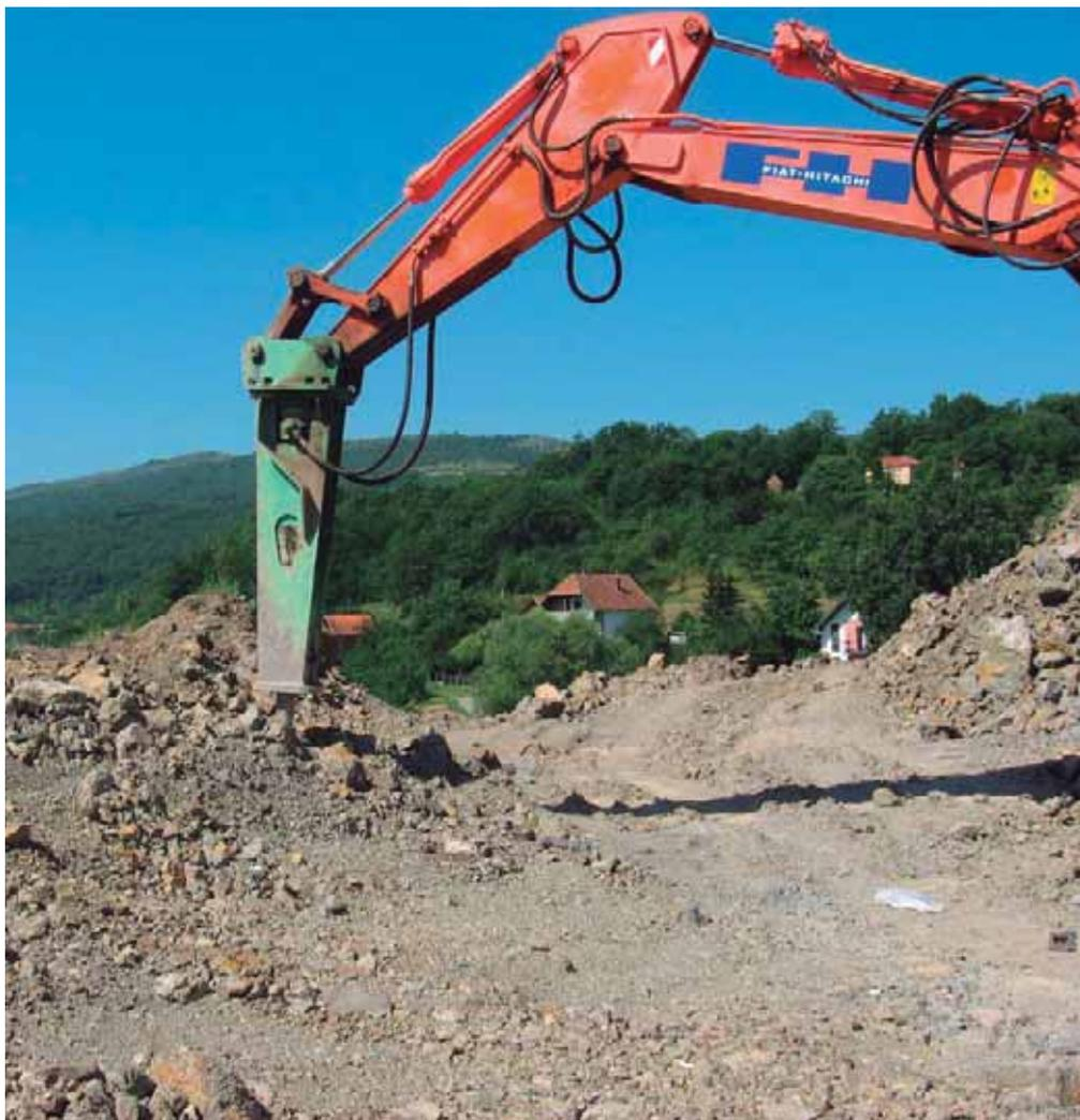
Potencia y versatilidad: ya sea para romper rocas, hormigón o de excavación, los martillos Montabert garantizan un rendimiento óptimo para cualquier tipo de obra.
