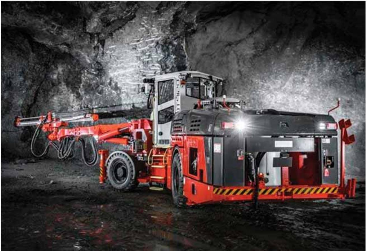
**S**andvik Construction ha introducido recientemente en el mercado un jumbo para perforación de túneles, modelo DT912D, que viene a completar su extensa oferta de jumbos para túneles. Diseñado especialmente para aplicaciones de piedra caliza, este nuevo jumbo de alto al-
