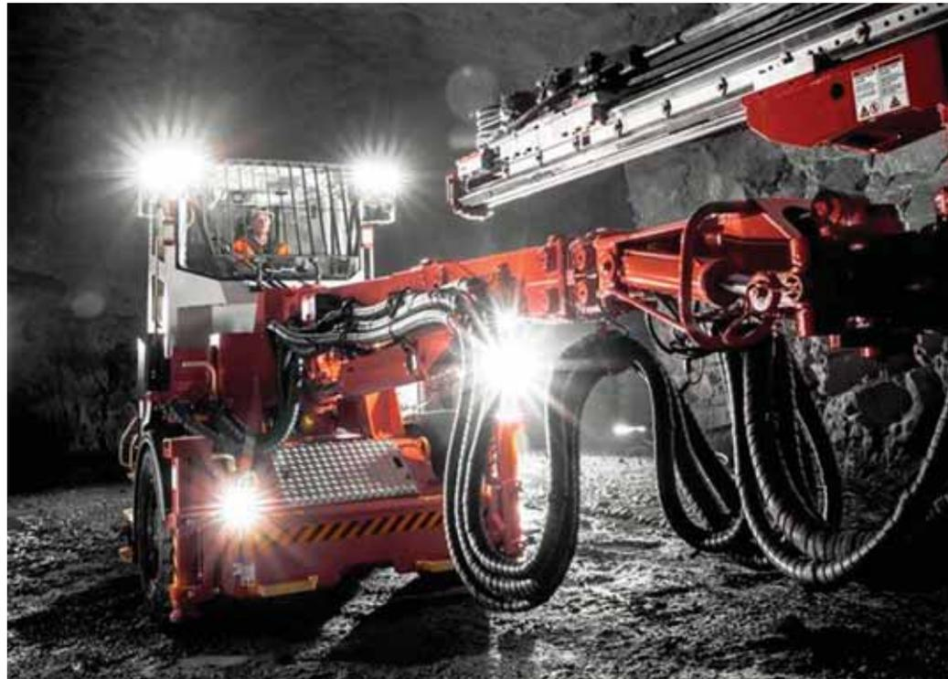
tomáticas agregadas, incluyendo automáticos de un hueco y está equipado con un brazo universal SB150 para una gran cobertura de forma óptima y paralelismo automático completo. Además de la perforación frontal, el brazo versátil también se puede utilizar para el corte
