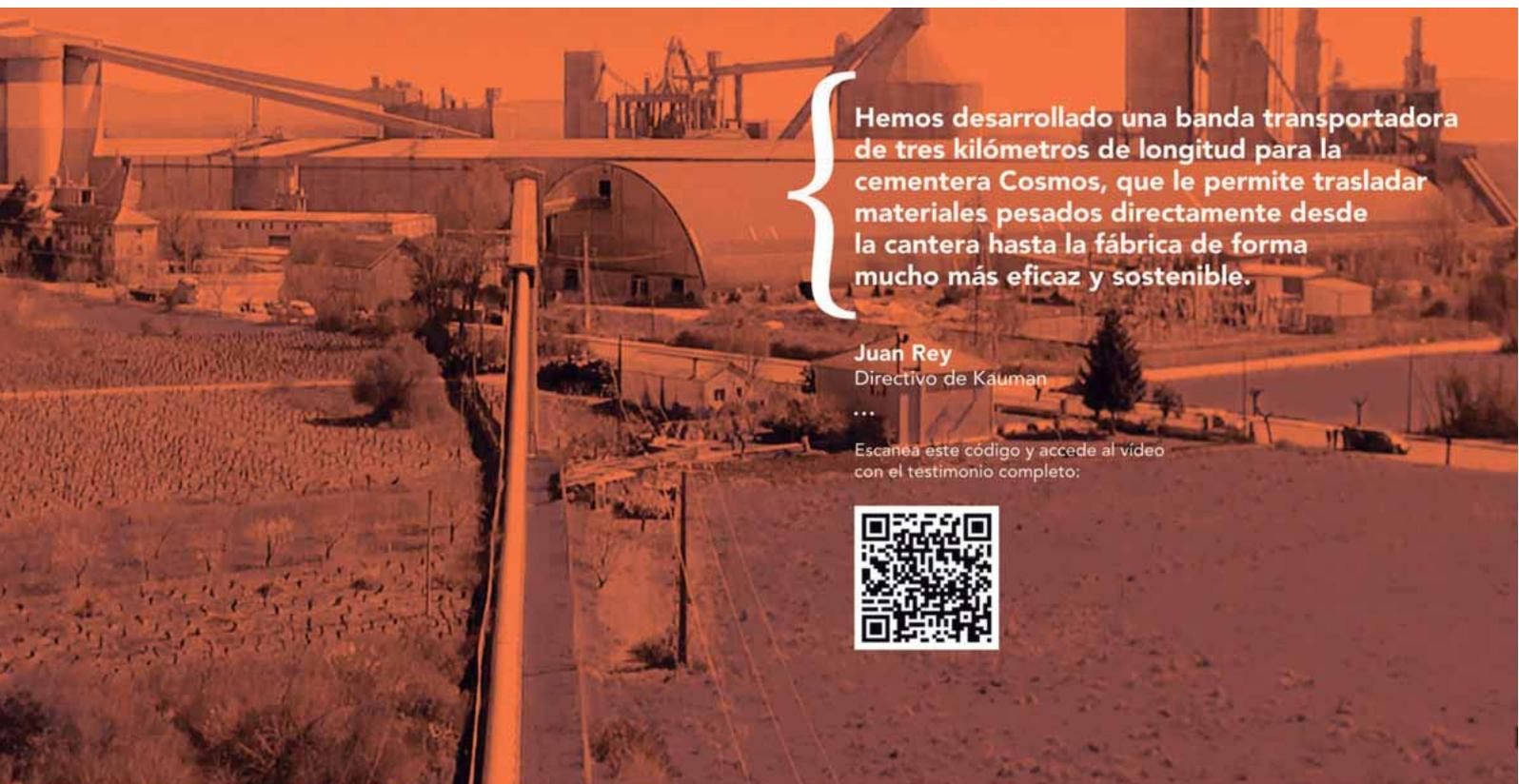
Hemos desarrollado una banda transportadora de tres kilómetros de longitud para la cementera Cosmos, que le permite trasladar materiales pesados directamente desde la cantera hasta la fábrica de forma mucho más eficaz y sostenible.
