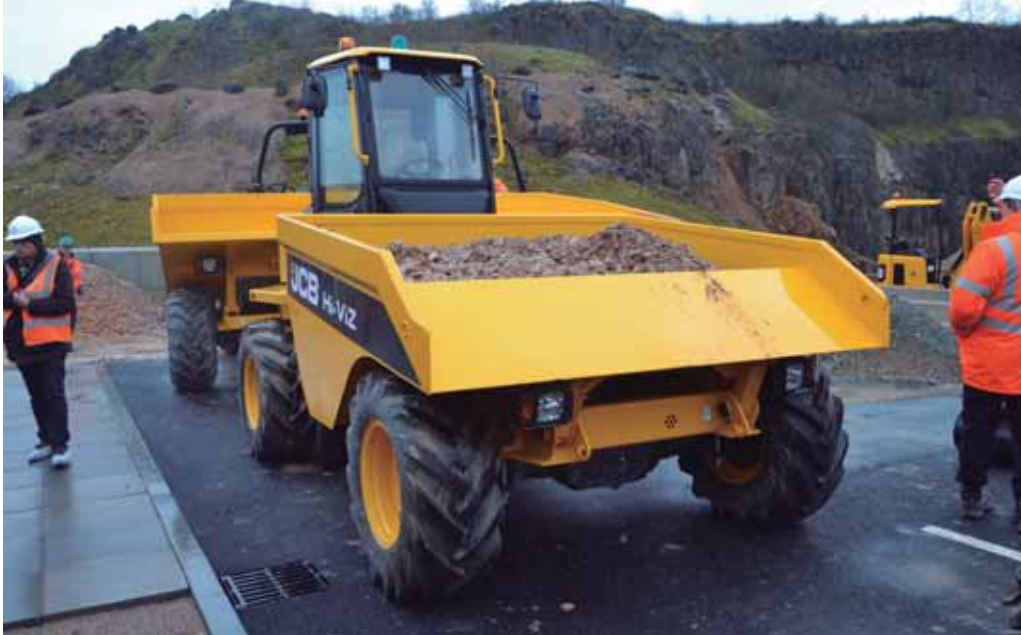
El dúmper de obra 7T-1 aumenta su estabilidad y visión con un centro de gravedad más bajo.
