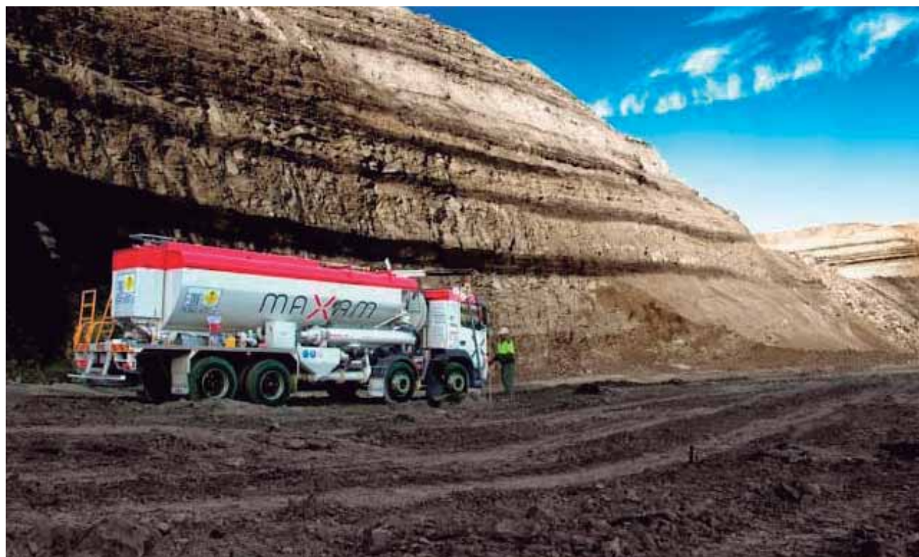
Figura 5: Camión fabrica en una voladura de alta energía.
