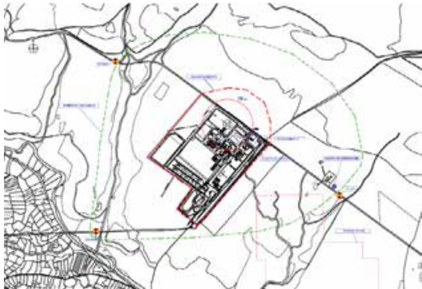
Perímetro de seguridad definido para el disparo de la voladura.
