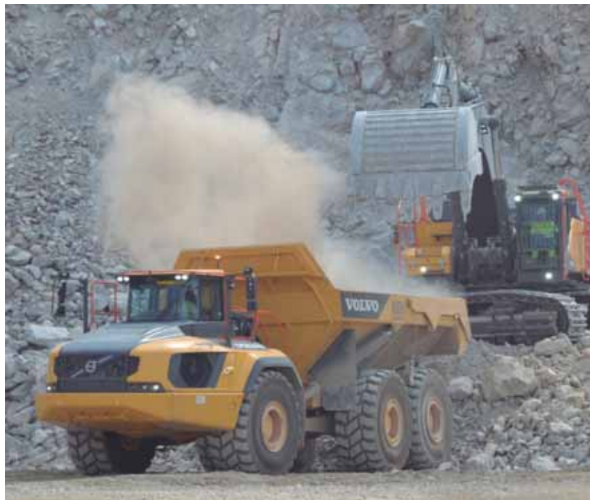
7 ciclos y 2 minutos de tiempo tarda la excavadora EC750E en cargar el dúmper A60H.
