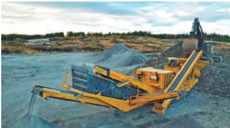
La trituradora de cono híbrida completa Keestrack H6e procesa productos finales de alta calidad a partir de una amplia variedad de materiales.
