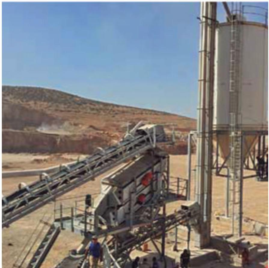
de banda es necesario la incorporación de un distribuidor vibrante. Los distribuidores vibrantes VD accionados por dos motovibradores
