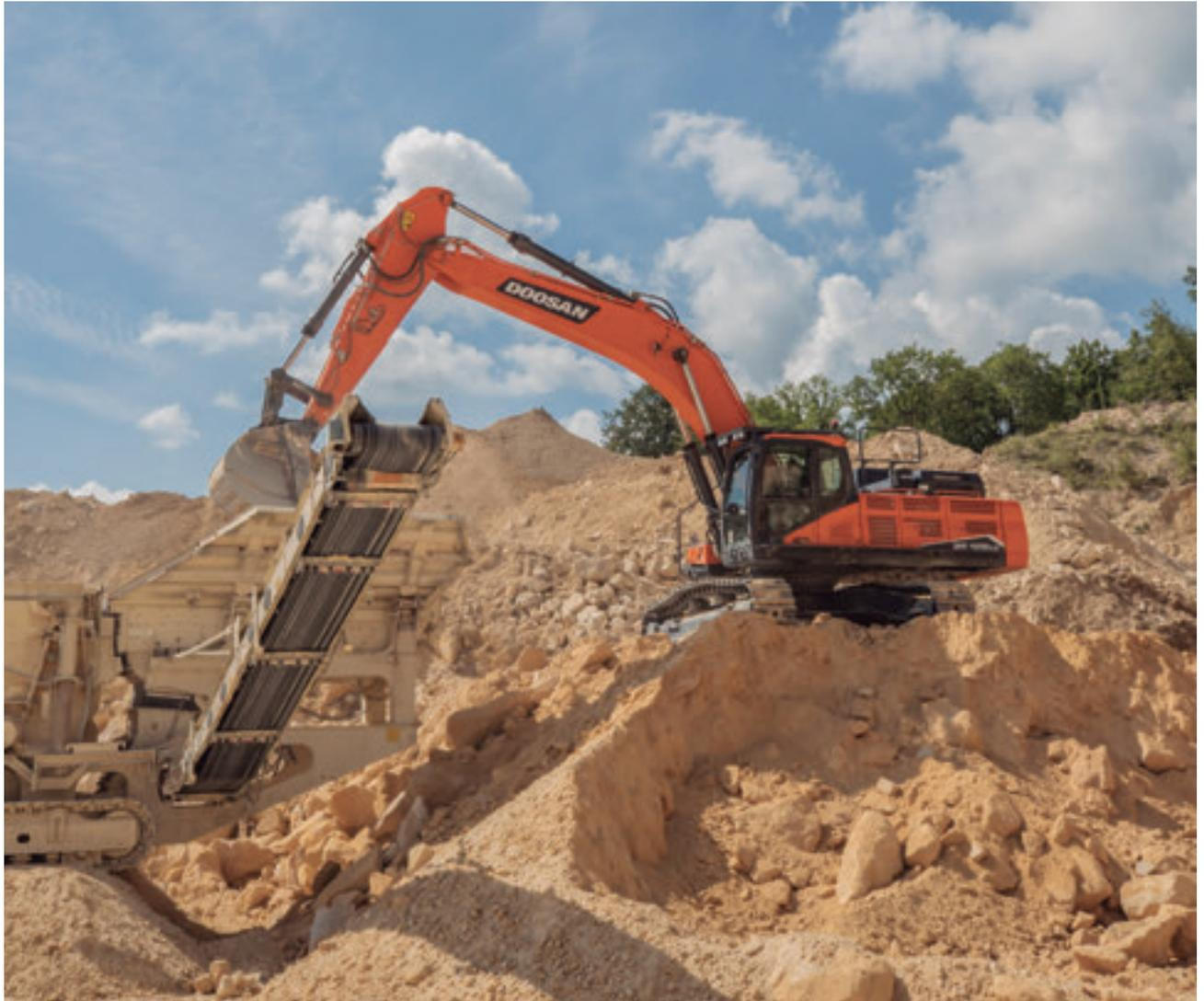
La nueva excavadora sobre orugas DX420LC-7 Fase V, de 43 toneladas, ha sido lanzada por Doosan Infracore Europe, ofreciendo la mejor eficiencia de combustible y productividad de su segmento. Para cumplir con la normativa Fase V sobre emisiones de motores, la excavadora DX420LC-7 está impulsada por el nuevo motor diésel Scania DC13 que cumple los requisitos de la Fase V, que proporciona una potencia de 257 kW (344,4 CV), el mayor motor en este segmento de máquinas.
